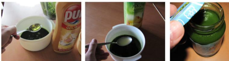
Byly přidány dvě lžičce Puru a tři lžičce ananasového džusu hry a stejné množství zmrazeného lihu, pro lepší vysrážení byla směs nalit do uzavíratelné nádoby a 30 min zamrazena.
